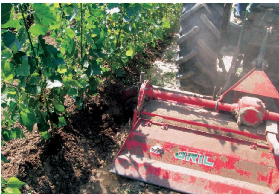
**Foto 9.** Rotovator con discos adyacentes para el control mecánico de malas hierbas en plantaciones en alta densidad. Se observa en el detalle el aporte de tierra sobre la hilera de plantación, lo que contribuye al control de las malas hierbas que crecen en la fila proporcionando, adicionalmente, un recalce de las plantas.
