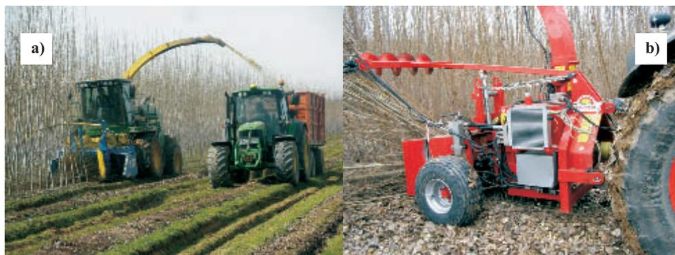
**Foto 20.** Máquina cortadora-astilladora: a) Autopropulsada, de la empresa Biopoplar ([www.biopoplar.com](http://www.biopoplar.com)) recolectando parcelas comerciales de chopo para biomasa en Italia. b) Accionada por un tractor agrícola, de la firma italiana Spapperi ([www.spapperi.it](http://www.spapperi.it)), en Soria.
