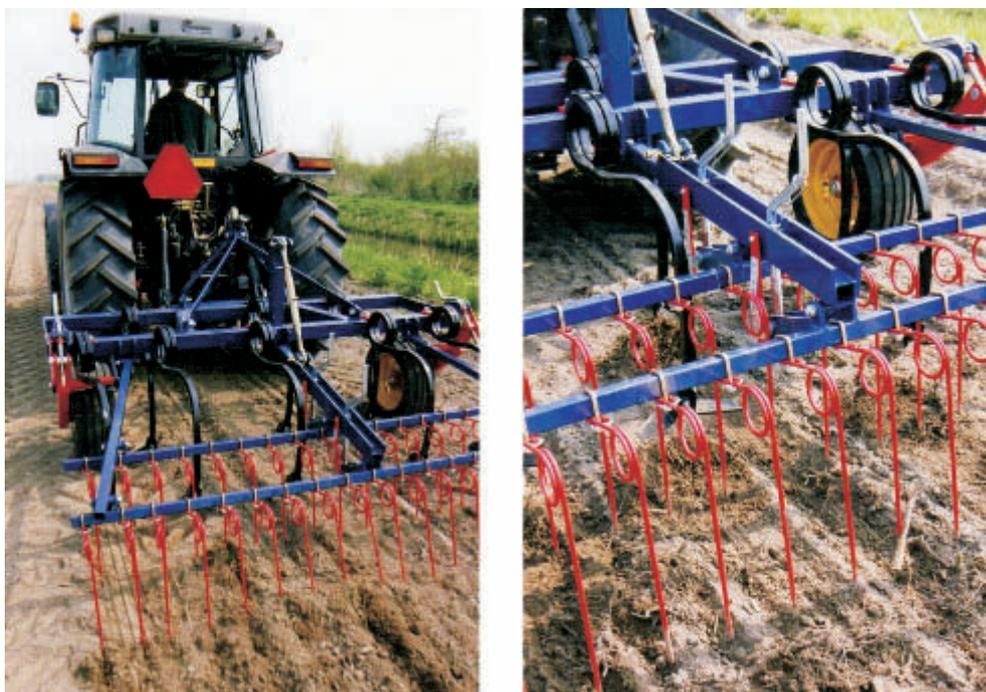
**Foto 8.** El control de las malas hierbas, especialmente en el primer año del cultivo, es fundamental para asegurar la instalación de la misma así como su rentabilidad. Existe maquinaria específica para la realización de un control mecánico de la hierba competidora como el que proporciona «Weedkiller» de la firma Salixfer ([www.salix.se](http://www.salix.se)).
