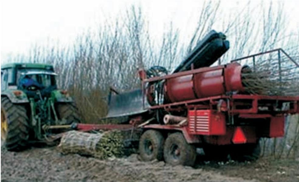
**Foto 22.** Máquina cortadora y compactadora de varas Bundler de la firma sueca Salixphere ([www.salix.se](http://www.salix.se)). Corta y compacta las varas en pacas cilíndricas.
