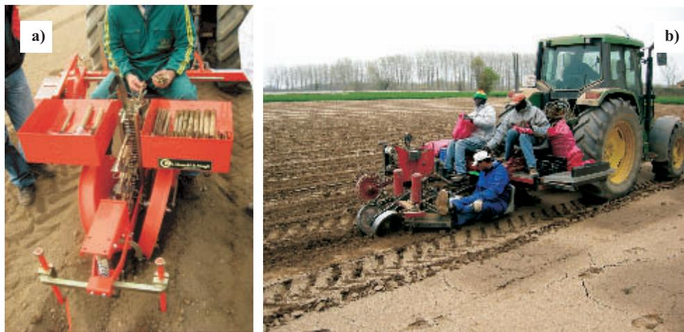
**Foto 16.** Maquinas plantadoras tradicionales de horticolas (a) y de frutales (b) adaptadas para la plantación de estaquillas de chopo con posibilidad de plantar varias filas simultáneamente.
