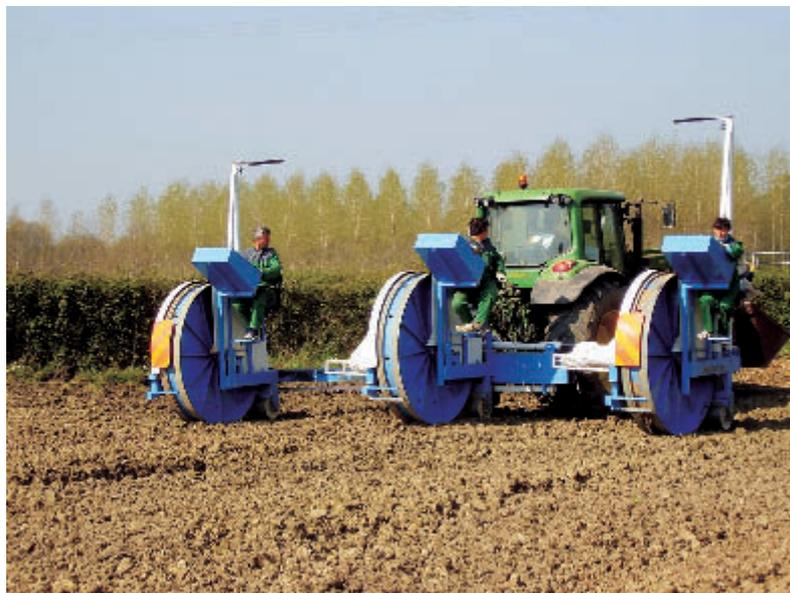
**Foto 18.** Máquina plantadora específica de estaquillas de cultivos leñosos para biomasa de la empresa Biopoplar operando en parcelas comerciales de Francia, plantando tres filas simultáneamente (cedida por Biopoplar, [www.biopoplar.com](http://www.biopoplar.com)).
