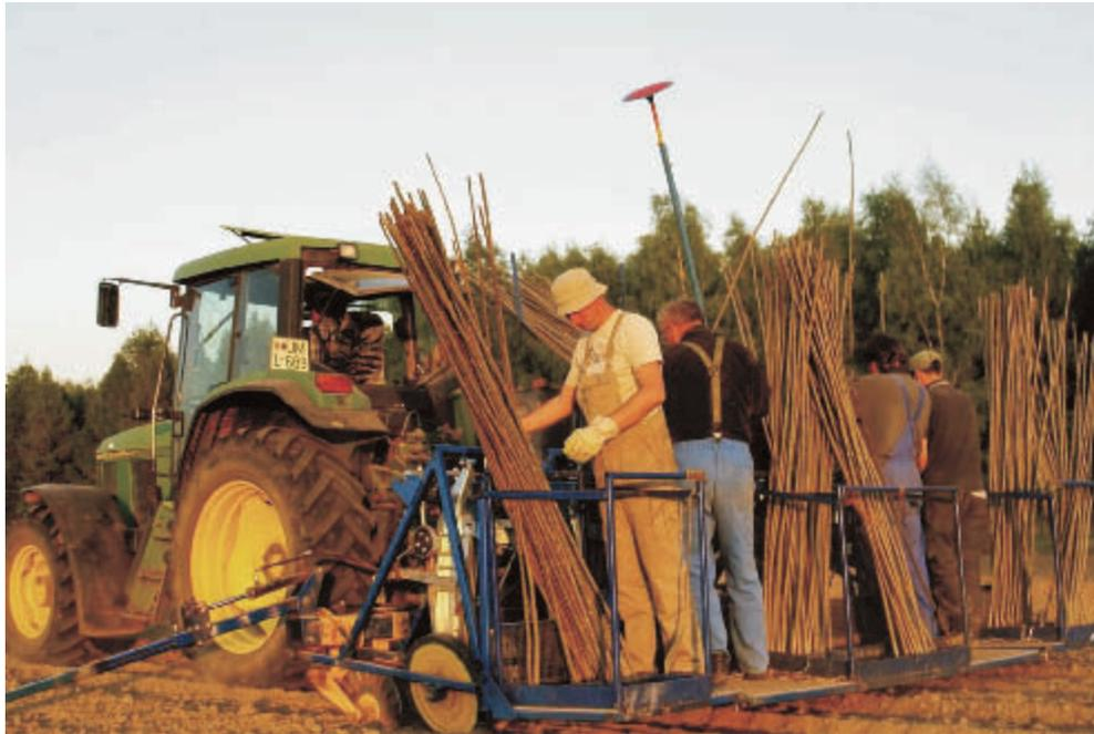
**Foto 5.** Plantadora «Step» de la firma Salixfer que se alimenta de varas ([www.salix.se](http://www.salix.se)). La realización de la estacilla y la plantación de la misma se realizan en una única operación. En este caso la plantadora realiza 4 filas de manera simultánea.
